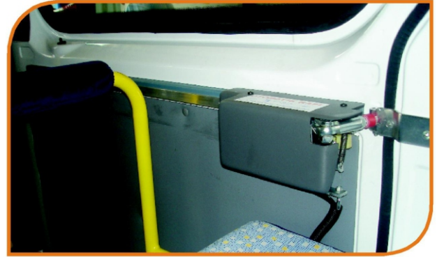
ENG003 sürgülü kapı motoru uygulaması ENG003 sliding door motor application
