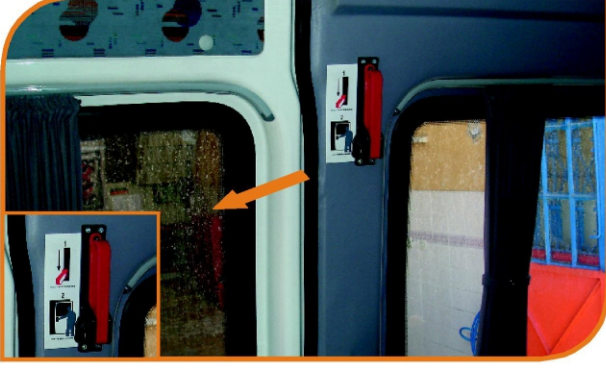
Sürgülü kapı güvenlik fitili Sliding door security cord
